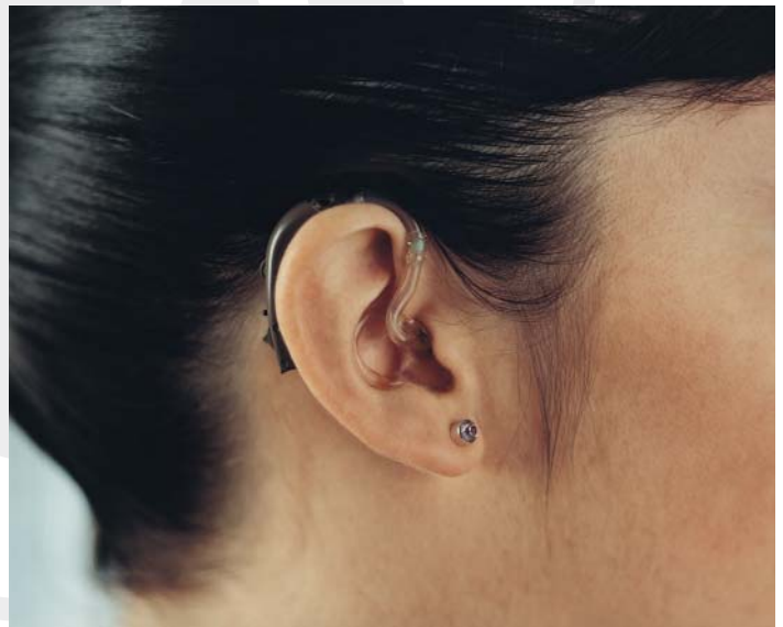
► Abb. 1 Das hier abgebildete Hinter-dem-Ohr-Gerät (HdO) kommt bei Hörminderungen aller Grade zum Einsatz. Daneben sind Im-Ohr-Geräte (IdO) bei leichten bis mittelgradigen Hörverlusten verbreitet. Quelle: Digital Vision.
